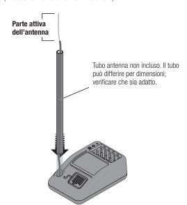
AVVERTENZA: non piegare, tagliare o danneggiare il cavo dell'antenna. L'antenna è composta da un cavo coassiale; in caso di danni alla guaina esterna, il ricevitore non può funzionare correttamente. In caso di danneggiamento dell'antenna, sostituirla prima di provare a utilizzare il ricevitore.
