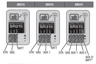
\*IMPORTANTE: AUX 3 su SR515 condivide la porta servo con la batteria. Un cablaggio Y (SPMA3008) è richiesto sulla porta AUX 3 per poter utilizzare tutti e 5 i canali con una batteria ricevitore.
