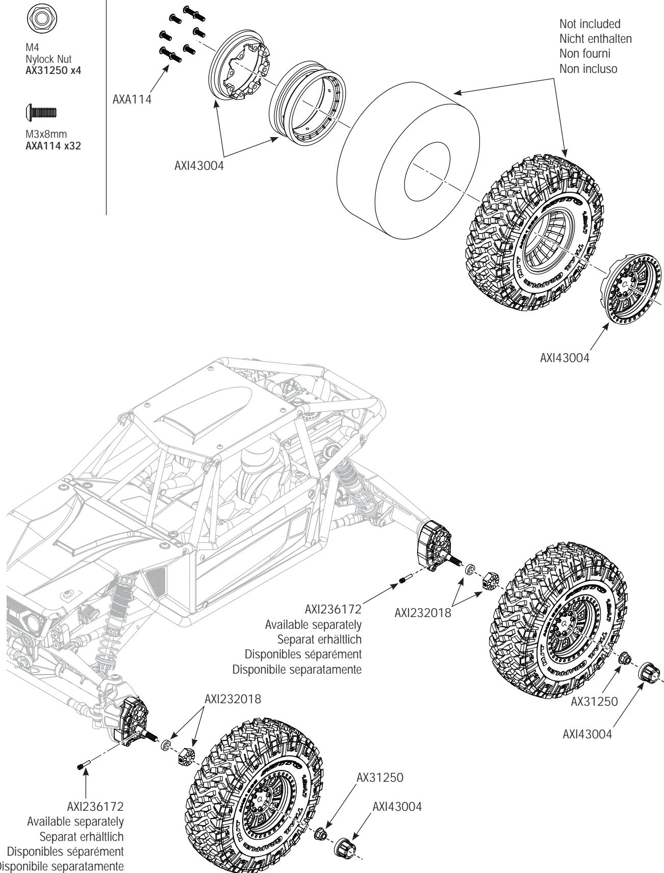
PARTS DIAGRAM | EXPLOSIONSZEICHNUNG | VUE ECLATÉE DES PIÈCES | ESPLOSO DEL MODELLO CON REFERENZA PEZZI
