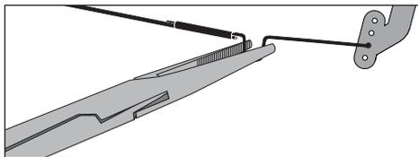
**Pour un fonctionnement optimal du système AS3X, il est important de ne pas utiliser les trims de façon excessive.** Si l'avion nécessite une correction importante aux trims (4 clics ou plus par voie), remplacez les trims à zéro et réglez mécaniquement les tringleries de façon à compenser les trims.
