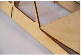
Fix the roof at ist cut outs with superglue
