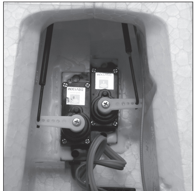
Impostazioni di fabbrica del timone e dell'elevatore Ancorine servo e aste di spinta
