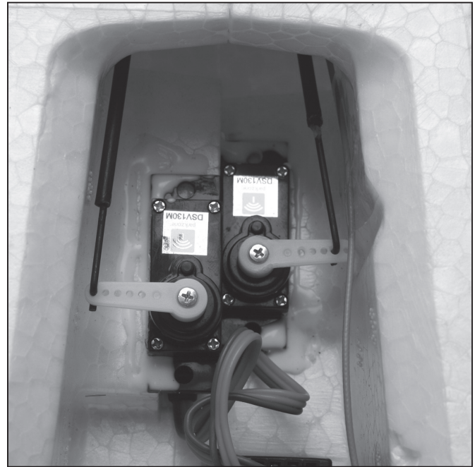
Réglage usine des gouvernes de direction et de profondeur Bras de servo et biellettes mécaniques
