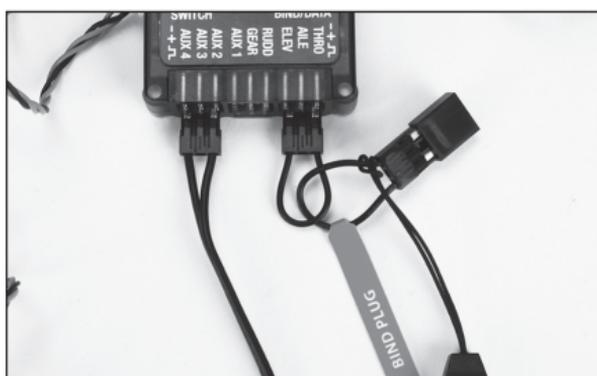
2. Schalten Sie den Ein/Aus Schalter ein. Die LED von allen angeschlossenen Empfängern werden jetzt blinken und damit anzeigen dass das System im Bindemodus ist.
